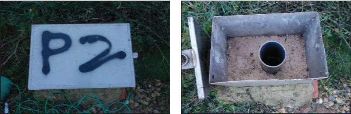
Fotografia 18a i 18b. Piezòmetre Pz-2.
