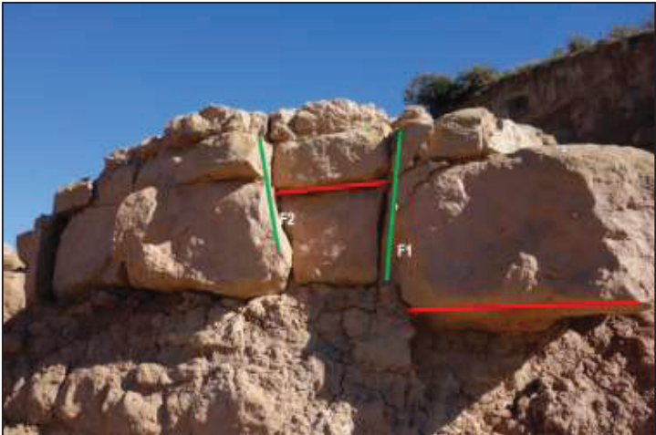
En color vermell es marca el pla d'estratificació i en color verd les diferents famílies de diaclasat principals (F1 i F2).
